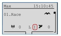
Bitte prüfen Sie auf dem Hauptbildschirm, ob die Durchkonstatierfunktion (BENZING INN) auf Ihrem Gerät verfügbar ist. Für die Durchkonstatierfunktion ist die neueste Firmware Version des BENZING Live SMART HUB sowie des BENZING M1 erforderlich.
