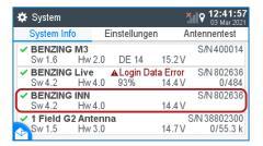
Im Bildschirm Systeminfo können Sie sehen, ob die Durchkonstatierfunktion (BENZING INN) auf Ihrem Gerät verfügbar ist. Für die Durchkonstatierfunktion ist die neueste Firmware Version des BENZING Live SMART HUB sowie des BENZING M3 erforderlich.
